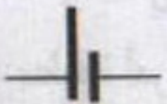
عمود كهربائي (بطارية أعمدة)
