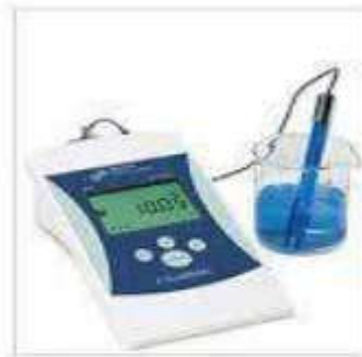
قياس دقيق الارتياب \Delta pH = 0,05
