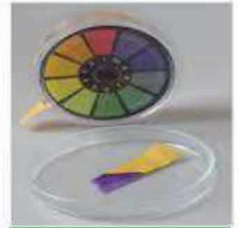
قياس تقريبي الارتياب \Delta pH = 1
